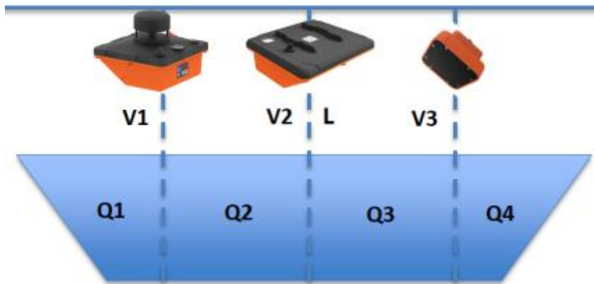
图 1-3 阵列式测流系统流量计算示意图
