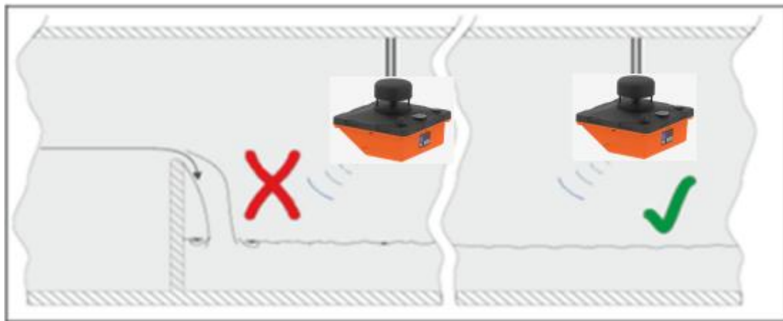
图 3-21 水面有落差的安装位置
