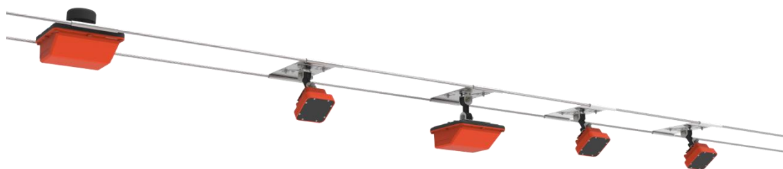
图 3-32 双缆道固定安装示意图
