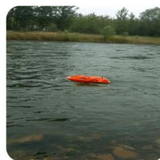
流速大于2m/s时船只不易控制，河道中水质含沙超过5公斤/立方米设备不能正常工作
